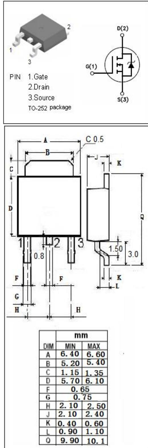
**isc N-Channel MOSFET Transistor****AOD2908****ELECTRICAL CHARACTERISTICS** $T_c=25^\circ\text{C}$  unless otherwise specified
