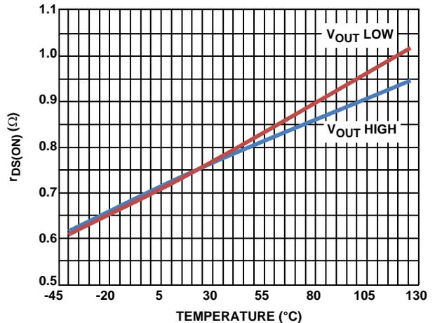
FIGURE 12. r<sub>DS(ON)</sub> vs TEMPERATURE
