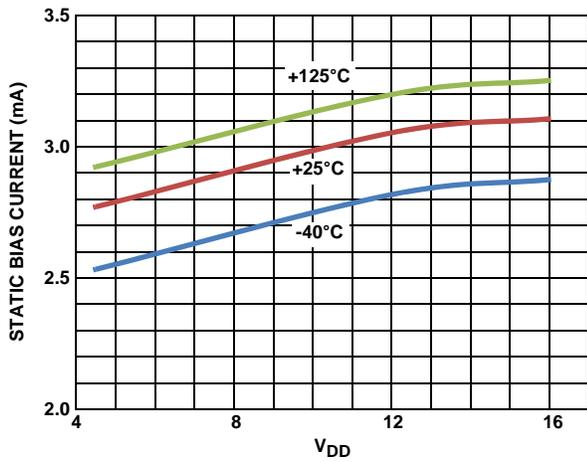
FIGURE 9. I<sub>DD</sub> vs V<sub>DD</sub> (STATIC)
