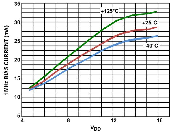
FIGURE 10. I<sub>DD</sub> vs V<sub>DD</sub> (1 MHz)
