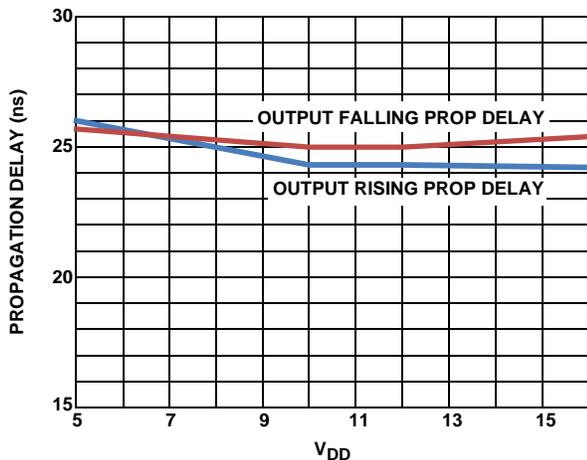
FIGURE 15. PROPAGATION DELAY vs V<sub>DD</sub>
