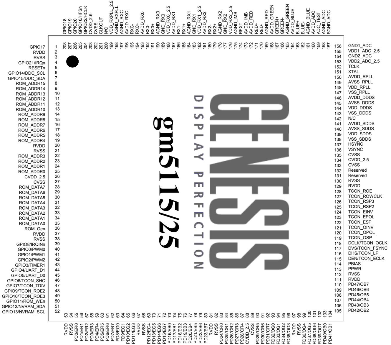
Figure 2. gm5115/25 Pin Out Diagram
