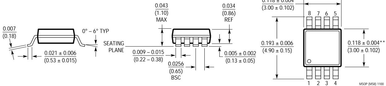
\* 寸法にはモールドのバリ、突出部、またはゲートのバリを含まない。モールドのバリ、突出部、またはゲートのバリは、各サイドで0.006 (0.152mm) を超えないこと。
